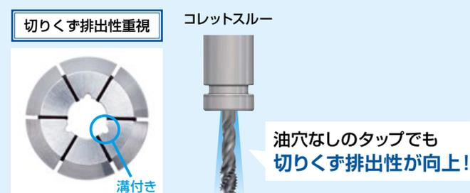
切りくず排出性を向上するコレットスルー用コレットです。外部給油と比べ圧倒的な切りくず排出性を実現します。
